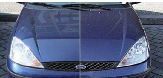
Abb. 6: Mit Nutzung eines Polarisierungsfilters (rechte Seite) können Reflexionen minimiert oder komplett unterbunden werden
