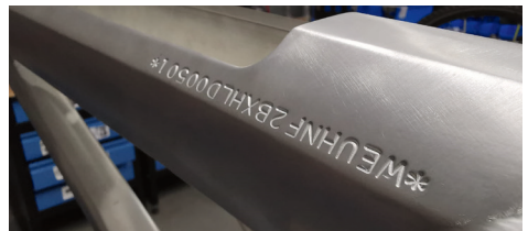
Abb. 7b: Nach Winkelkorrektur: bessere Sicht auf die FIN ohne größere Reflexionen
