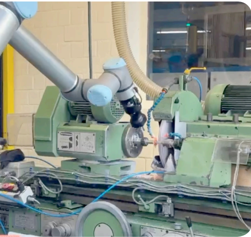
Abb. 1: Verknüpfung eines Cobots mit einer Bestandsanlage Urheberin: Dr. Sandy Speck
