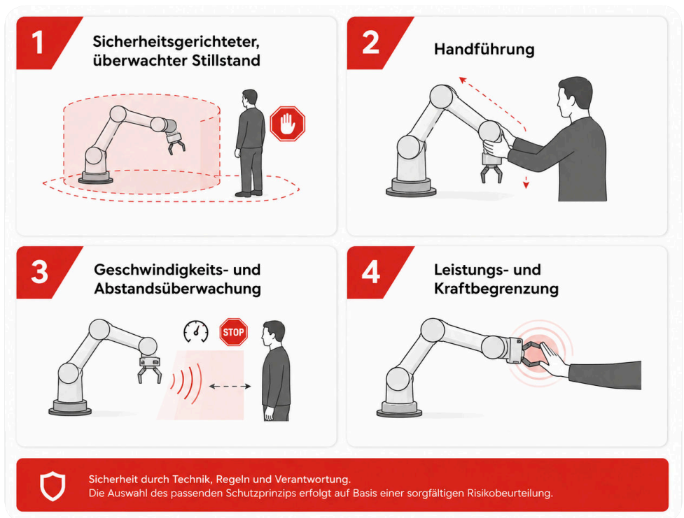
Abb. 24: Vier Prinzipien von Sicherheitsfunktionen, KI-generiert, inhaltliche Quelle: [10]
