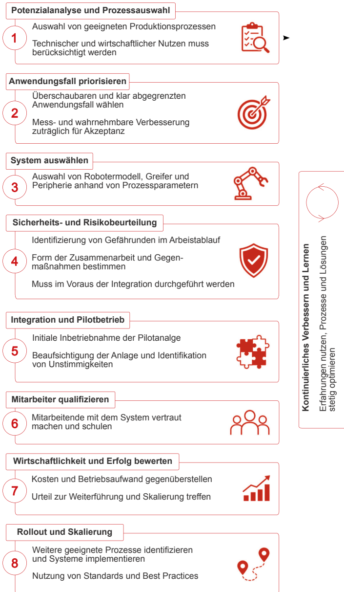
Abb. 25: 8 Schritte zur Integration von Robotersystemen im Unternehmen, selbst erstellt, inhaltliche Quelle: [11]
