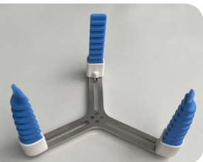
Abb. 12: 3-Fingergreifer am Beispiel eines Softgrippers
