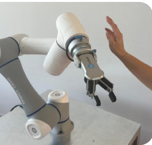
Abb. 22: Schutzhaut mit integrierter Abstandssensorik
