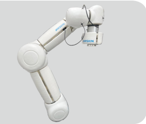
Abb. 20: Drucksensible Schutzhaut an einem Robotersystem
