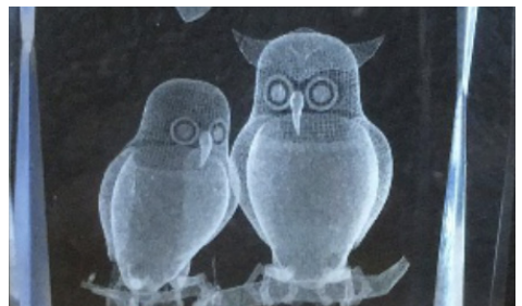
Abb. 16: Mit Hilfe eines Lasers kann nicht nur die Oberfläche, sondern auch das Innere eines Glaskörpers bearbeitet werden, sodass ein 3D-Effekt erzeugt werden kann.
