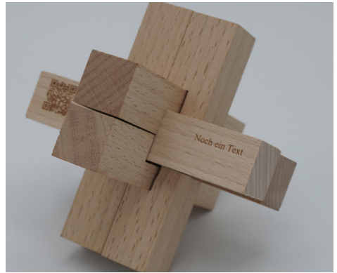
Abb. 9: Beispiel für eine Holzbearbeitung mit einem CO 2 -Laser. Hier wurde ein QR-Code und ein Text graviert.
