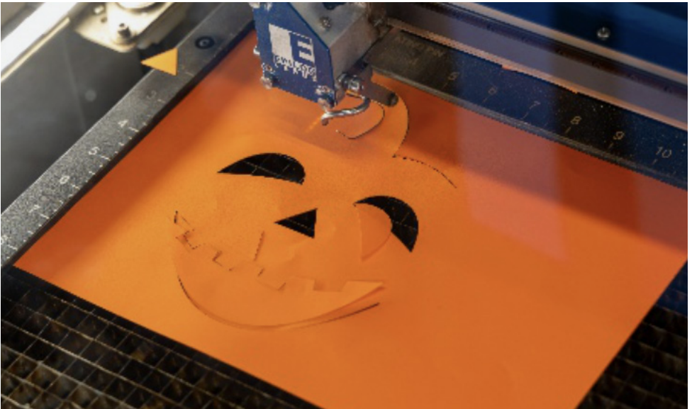
Abb. 13: Schneiden eines Kartons als Bastelvorlage
