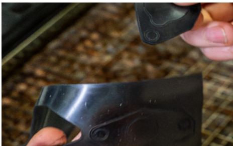
Abb. 11: Passgenaue Dichtungen durch präzises Laserschneiden.
